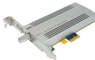
Figure: DekTec DTA-2111 digital modulator
